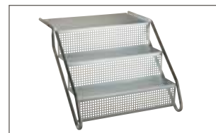
Hjælpetrappe stål Belastning op til 350kg 3 trin: Trindhøjde 164mm 4 trin: Trindhøjde 167mm 5 trin: Trindhøjde 180mm
